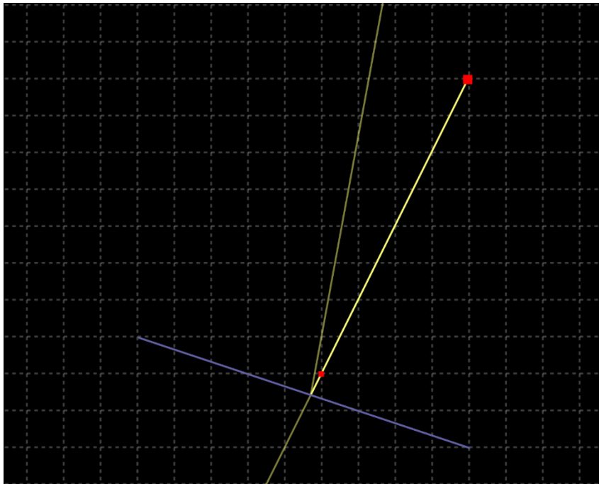
Abb. 21 Reflexion eines Sonnenstrahls an der ersten Glasschicht (in blau) eines 20° geneigten Photovoltaikmodul bei dem maximalen Einfallswinkel am Standort (einfallender Strahl mit roten Quadraten)
